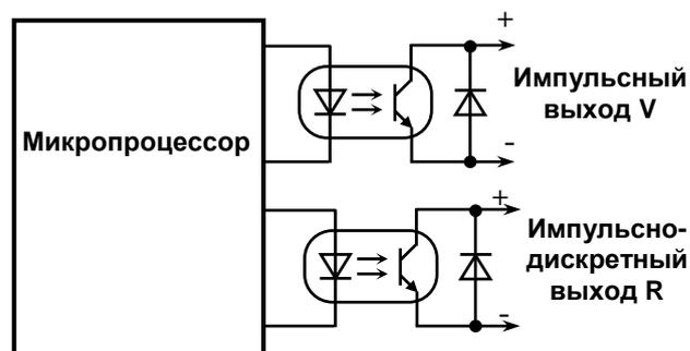
Рисунок 3.5 - Организация выходов преобразователей модификации МФ исполнения Р
