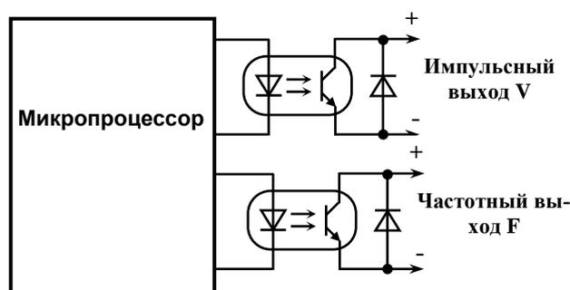
Рисунок 3.3 - Организация выходов преобразователей модификации МФ-Ч
