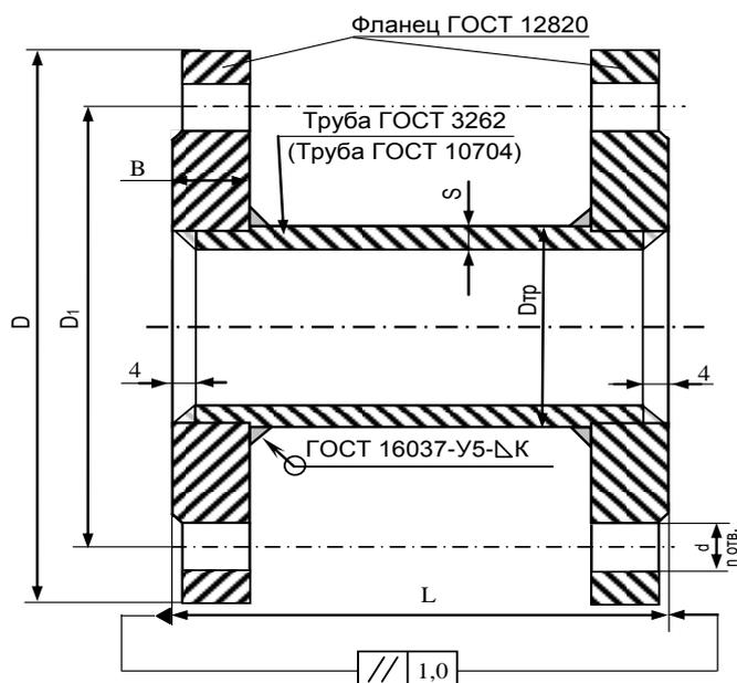
Рисунок А.7 – Макет фланцевый приборов исполнения МФ-7.2Х, МФ-5.2Х
