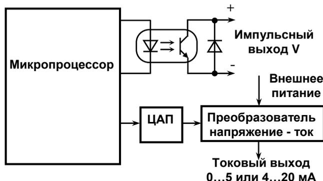
Рисунок 3.4 - Организация выходов преобразователей модификации МФ-Т
