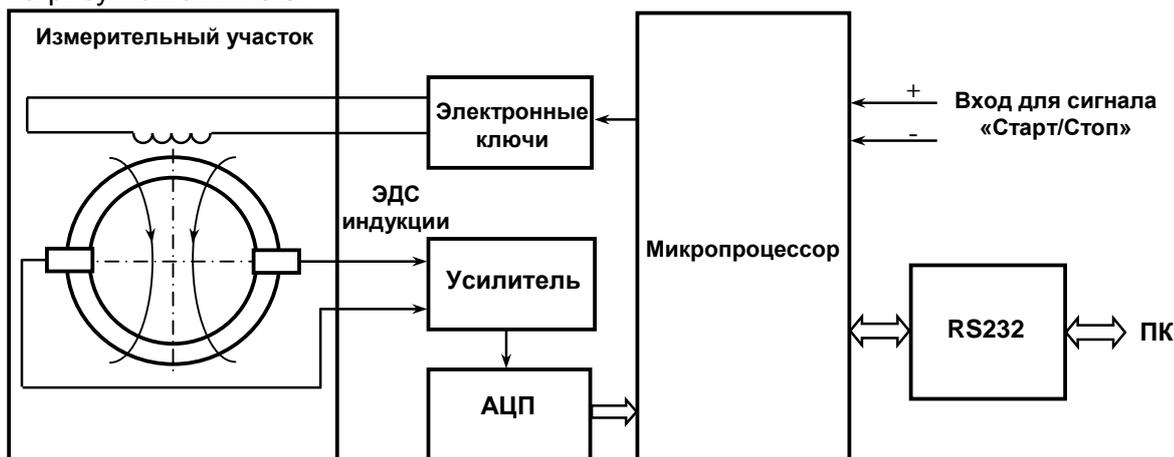
Рисунок 3.1- Структурная схема изделия
