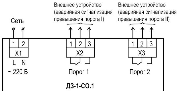
Рисунок 4 – Функциональное назначение клемм прибора
